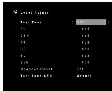
Todos los altavoces del sistema aparecen con su configuración de nivel actual. Puede ajustar el nivel de cada altavoz entre -10 dB y +10 dB y en incrementos de 1 dB.
